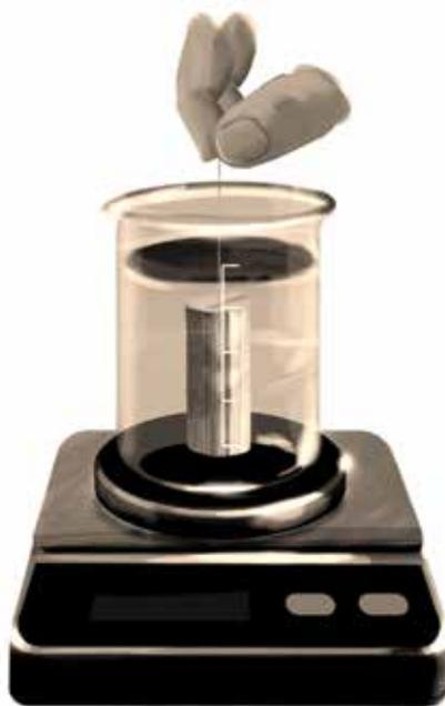
**Figura 1.** Medición del volumen de la muestra de madera por medio del desplazamiento de agua.
