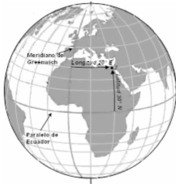
Figura 3.4.2 Medición de la latitud y la longitud
