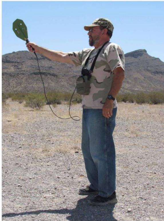
**Figura 9.- Fotografía de un subsistema de recepción en el cual se utiliza una antena de paleta (Fotografía M. Hidalgo).**
